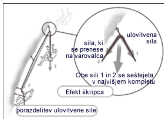
Slika 19: Porazdelitev ulovitvene sile.
